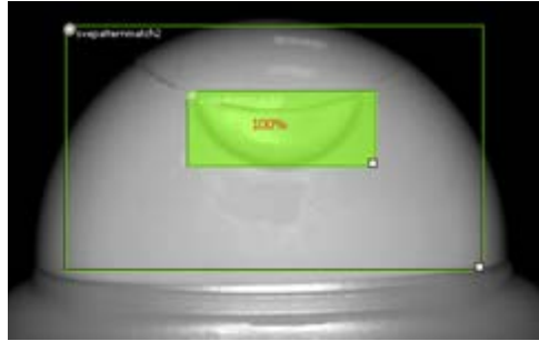
Obr.7-4a: Uzávěr šamponové lahvičky: OK
