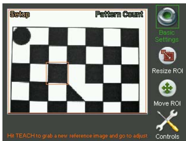
Obr.7-14: Obrazovka počítání vzoru (Pattern Count)
