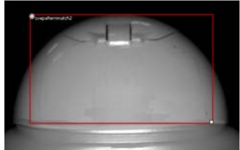
Obr.7-4b: Uzávěr šamponové lahvičky: NOK
