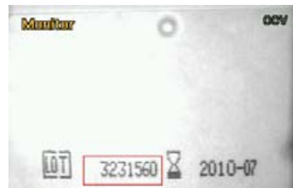
Obr.7-3b Typový kód je na části poškozen nebo částečně vytištěn!
