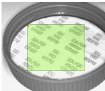
Obr. 7-2a Kontrola přítomnosti potisku OK
